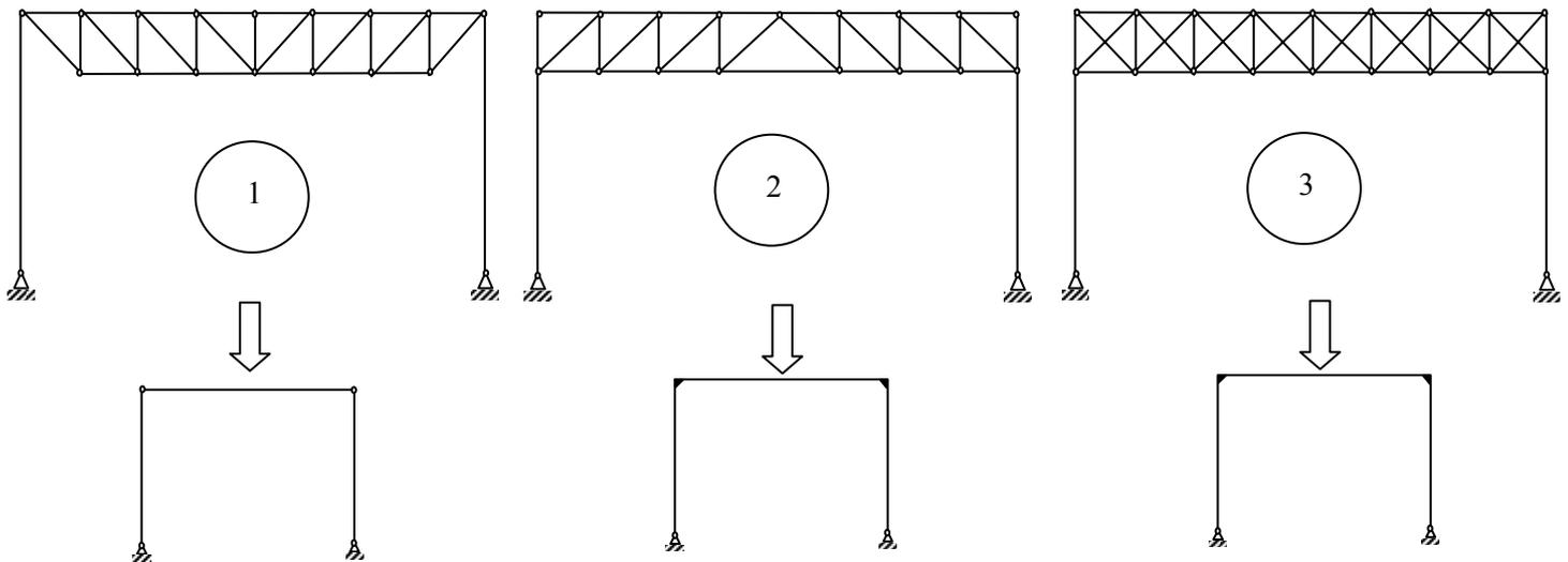
Chaque cadre représente le système statique dessiné ci-dessus. Par conséquent, la structure 1 est un mécanisme (instable) **extérieurement** (c'est-à-dire dans ses appuis et liaisons) alors que les structures 2 et 3 sont hyperstatiques.
